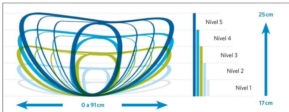
O **StrideGuide™**: ilustra a relação entre comprimento e altura da passada, conforme apresentado neste diagrama.
